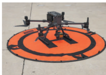
計測機器を付けたドローン
